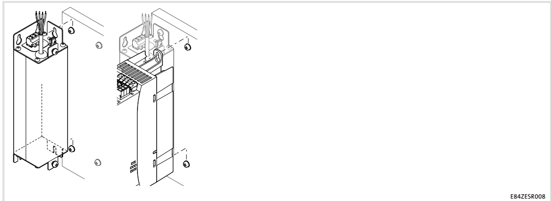
Abb. 5-6 Montage mit Nebenbaufilter
