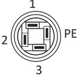
**Steueranschluss X1 mit M12-Steckverbinder A-codiert, Stifte**
