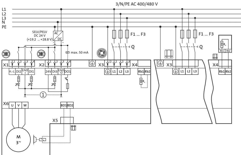
① GND ist gebrückt, wenn auf dem Typenschild die Ausführung "DI/DO-GND bridged" angegeben ist.
